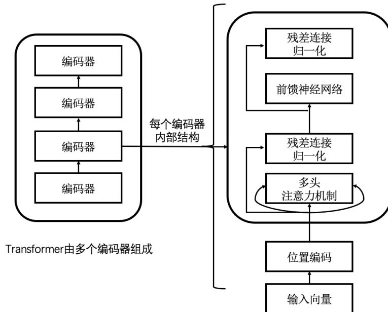
图 3 标准 Transformer 编码器结构
