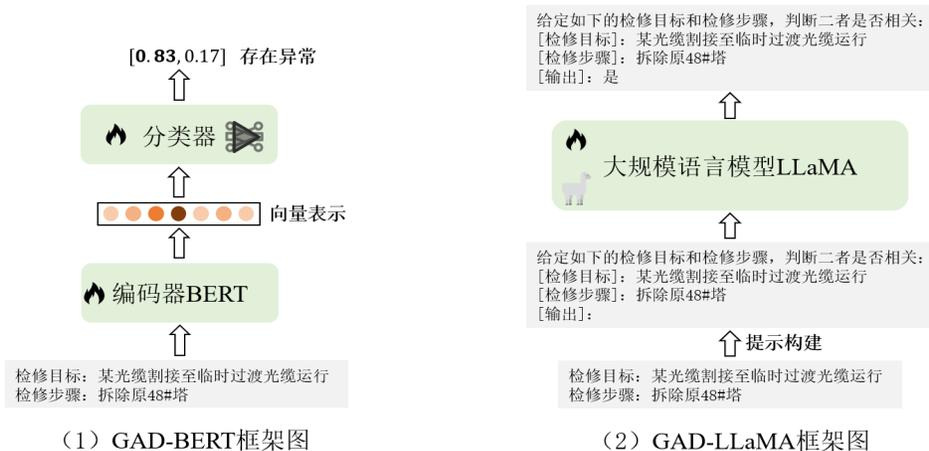
图 2 检修计划异常检测模型框架图
