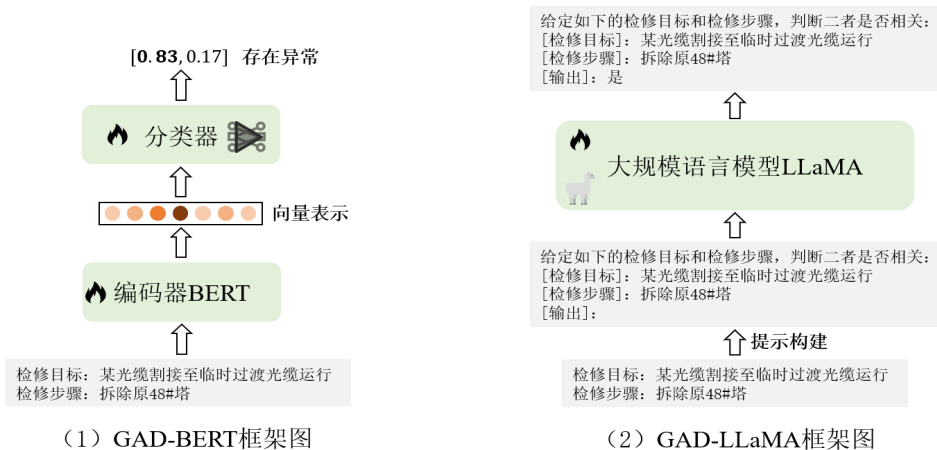
图2 检修计划异常检测模型框架图
